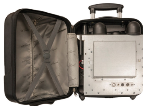
Specijalna, kamuflažna prijenosna verzija PIK-GAT-a namijenjena za pješakačke patrola i timove, bez ugrađenog gatewaya za vozilo
