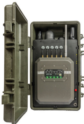
Specijalna robusna prijenosna verzija PIK-GAT-a namijenjena na pješakačke patrola i timove, bez ugrađenog gatewaya za vozilo.
